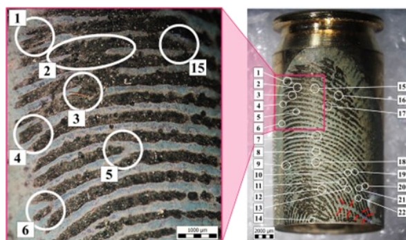
Obr. 2. Porovnání modelového otisku prstu vyhotoveného pomocí daktyloskopické podušky a daktyloskopické stopy elektrochemicky vizualizované depozicí PTB na mosazné nábojnici.
