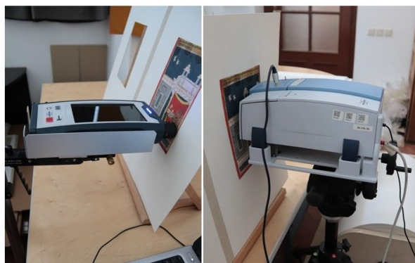
Obr. 1. Neinvazivní průzkum metodou Ramanovy a infračervené spektroskopie
